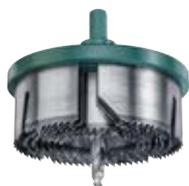
Con ranuras patentadas para un mayor y mejor rendimiento. Sierra de corona, 7 piezas, plato de apoyo de cinc colado a presión, coronas de acero templado para muelle, puntas de los dientes templadas por inducción, para el uso en madera, maderas revestidas de plástico, madera dura, planchas de conglomerado, planchas de yeso encartonado, placas de construcción ligera, plástico y cobre.
